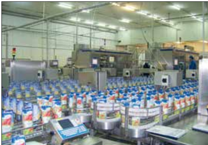
Zautomatyzowana linia produkcyjna soków w opakowaniach kartonowych
